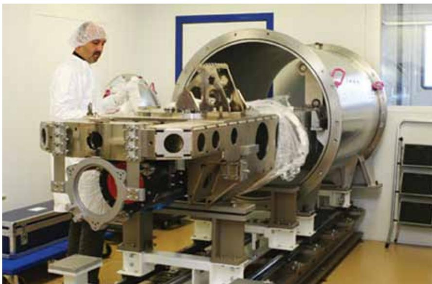
Assemblaggio dello spettrografo HARPS-North, che diventerà presto uno dei partner terrestri della missione Kepler, e il più preciso cacciatore di pianeti dell'emisfero boreale.
